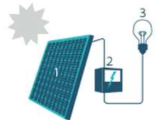
1. Zonnepaneel | 2. Omvormer | 3. Elektrische toestellen
