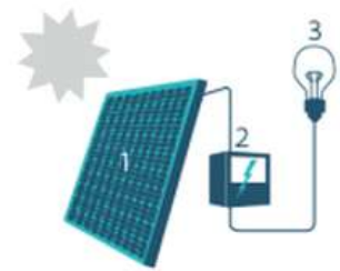
1. Zonnepaneel | 2. Omvormer | 3. Elektrische toestellen
