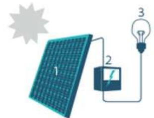
1. Zonnepaneel | 2. Omvormer | 3. Elektrische toestellen
